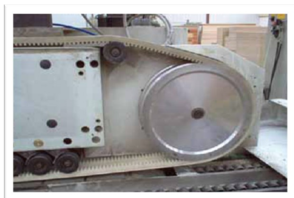
Cinghie Voltapower con superficie antimacchia per squadatura pannelli
