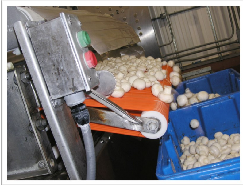
Cinghie termosaldabili in PU per trasporto funghi
