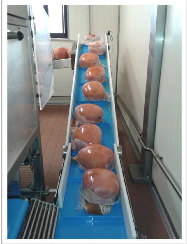
Nastro VOLTA con profili per trasporto prosciutti cotti.
