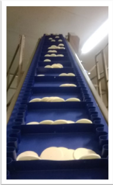
Nastro in PU per trasporto prodotti a bassa temperatura
