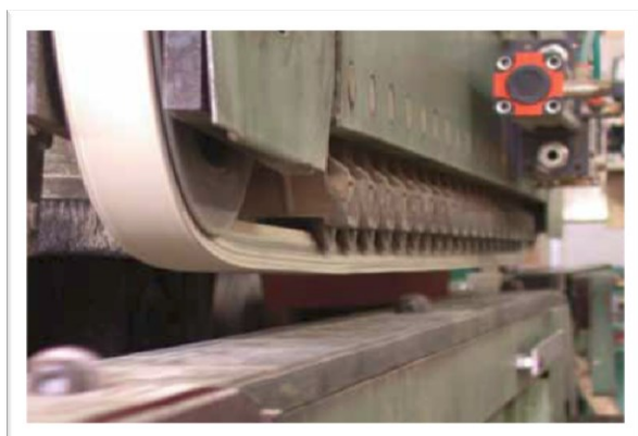
Cinghie Voltapower con superficie antimacchia per squadatura pannelli
