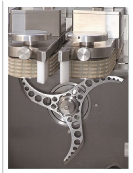
Cinghie dentate rivestite con superficie ad alto grip per trasporto salsicce
