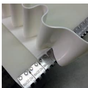
Giunzione metallica a chiodi su nastro con bordi di contenimento
