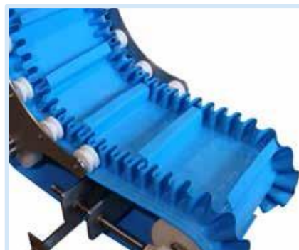
Elevatore SuperDrive™ con profili, guide e bordi di contenimento
