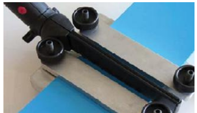
Saldatura di nastro piatto con pinza P-200
